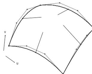
図 4: 1 階偏微分ベクトルに基づく制御ベクトル
