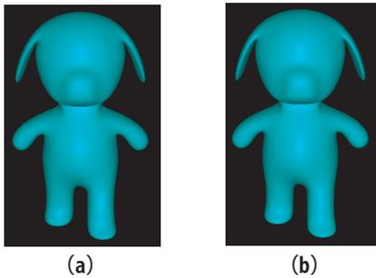
図 8: (a) 曲線メッシュ曲面のシェーディング表示 (b) 細分割曲面のシェーディング表示
