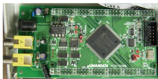
図 2: 試作した GD 制御ユニット GDC
