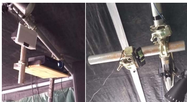
図5. プロジェクタと赤外線照明 (左) カメラ (右) の設置
