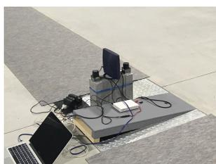
図5 軌道中心に設置した2台の二次元 LiDAR
