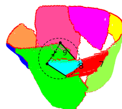
図10 誤差の蓄積による形状不一致例
