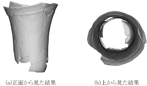
(a)正面から見た結果 (b)上から見た結果 図 21 手作業の結果で得られた三次元点群データ
