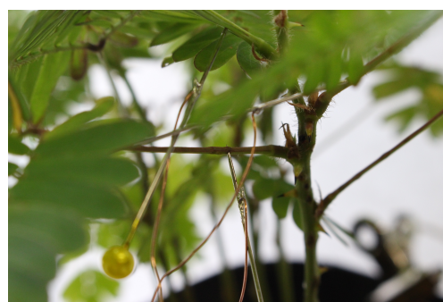
図 3 マチ針による個別制御のための接続
