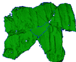
図 10 元データと生成したトリム曲面の合成
