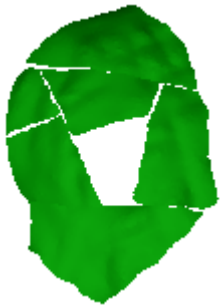
(b) ローパスフィルタを 1000 回適用したポリゴン [面数 40623]
