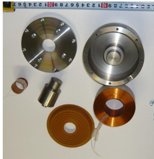
参考図 3 16cmφ電磁石 speaker（ホーレイコーン紙 - 最上電機）
