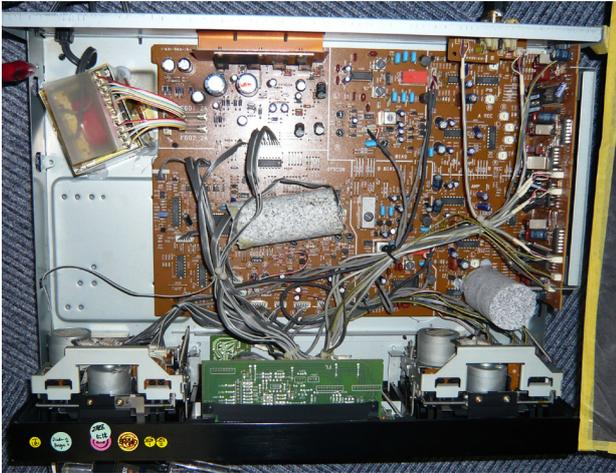
図 5 石片による制振
