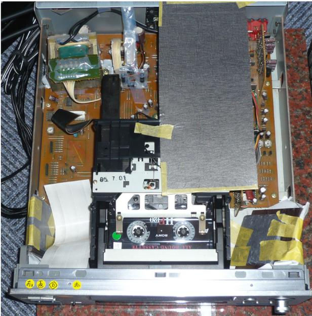
図 6 電磁シートによる電磁妨害吸収
