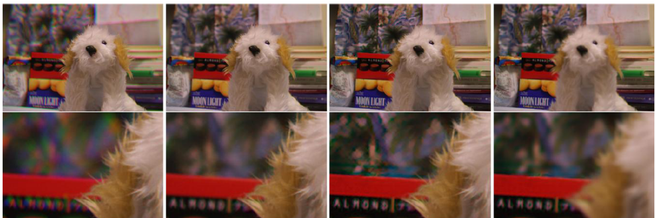
図 3: 左から順に、撮影画像, 色ずれ解消結果, 焦点ボケ除去結果, ピント変更結果（下段は上段の一部を拡大した図）
