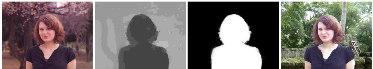
図 2: 左から順に、撮影画像, 奥行き推定結果（輝度が高いほど遠い）, マット抽出結果（白が前景, 黒が背景）, 異なる背景への合成結果
