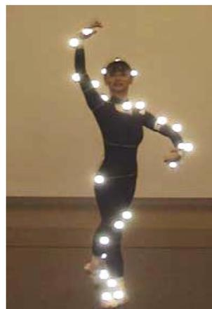
図2 光学式モーション・キャプチャ・システム
