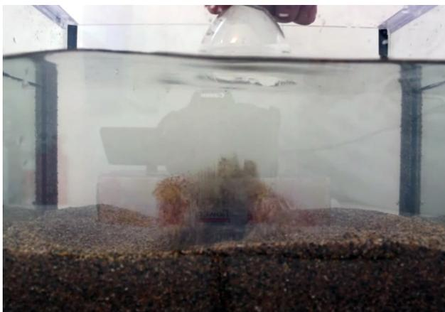
図2 水槽での砂塵拡散現象観察実験
